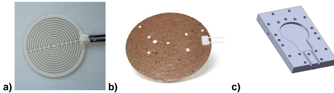
Abbildung 4-10 (a) Nickel-Heizstruktur auf Keramiksubstrat ( \varnothing 38,1 mm) (b) kommerziell erhältliches Heizelement ( \varnothing 38,1 mm) (c) Endplatte zum Einbau eines Heizelementes
